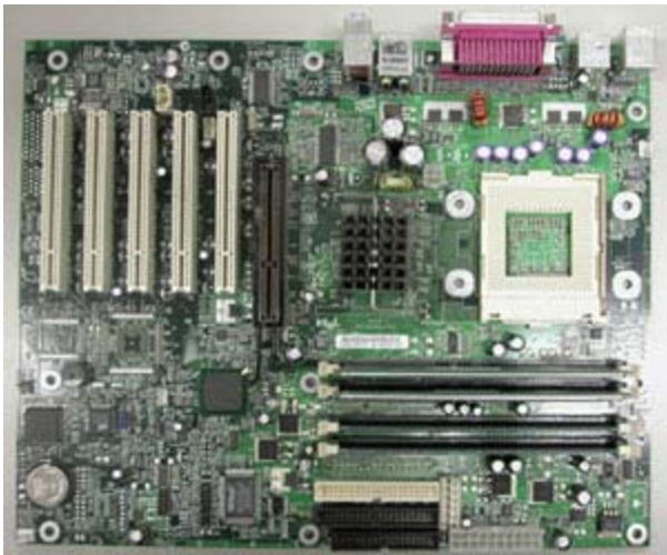
Asus P4B533-E: esempio di motherboard ATX per Intel Pentium 4 basata sul chipset Intel 845e
