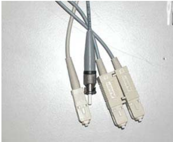
Alcuni esempi di connettori per reti in fibra ottica
