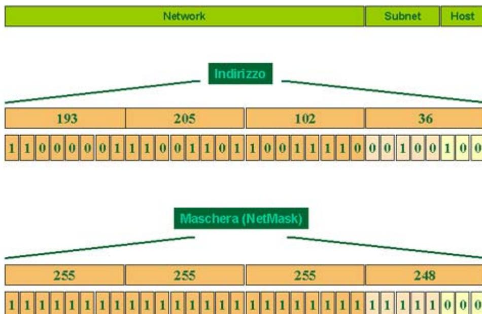
L'ampiezza dei campi *subnet* e *host* viene definita tramite un parametro detto *netmask*. La *netmask* contiene bit a uno in corrispondenza dei campi *network* e *subnet*, e a zero in corrispondenza del
