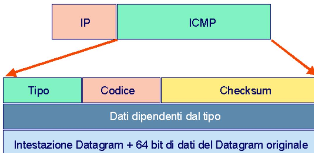
IP non possiede meccanismi di indicazione o correzione degli errori, ma si affida a un modulo denominato *Internet Control Message Protocol* (ICMP) per la segnalazione degli errori sopravvenuti nel corso dell'elaborazione di un datagramma e per la generazione di messaggi amministrativi e di stato. ICMP risiede in ogni *computer host* o *router* come protocollo abbinato a IP. ICMP viene
