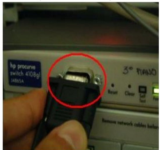
Interconnessione del cavo seriale all'apparato attivo
