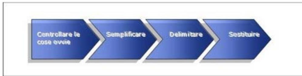
Le metodologia da seguire per isolare le cause di un malfunzionamento si può, semplificando, riassumere nelle operazioni riportate nel diagramma in figura che vanno ripetute iterativamente fino alla risoluzione del problema o alla constatazione della necessità di un risolutivo intervento del servizio di assistenza del fornitore.
