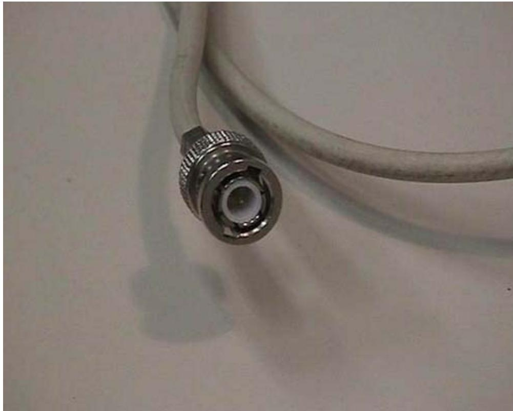
Questa che vedete è una connessione utilizzata nelle vecchie reti: viene ancora usata dove non è economico sostituirla. Si chiama connessione BNC ed è pensata per cavi coassiali infatti ha una parte esterna tonda che si collega alla massa e una parte centrale che si collega al centro del cavo coassiale. In un'altra parte del filmato vedremo come questo tipo di connessione e questi cavi vengono utilizzati per poter operare nei vecchi modelli di reti.
