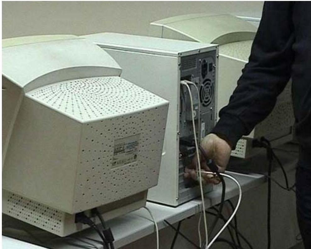
Il computer C 17 ha questo cavo. Seguendo quindi il cavo che parte dalla presa C 17 trovo la posizione fisica del computer. Questo è il computer collegato alla presa C 17 la quale sarà associata nell'armadio al C 17 del patch pannel che a sua volta è collegato allo switch.
