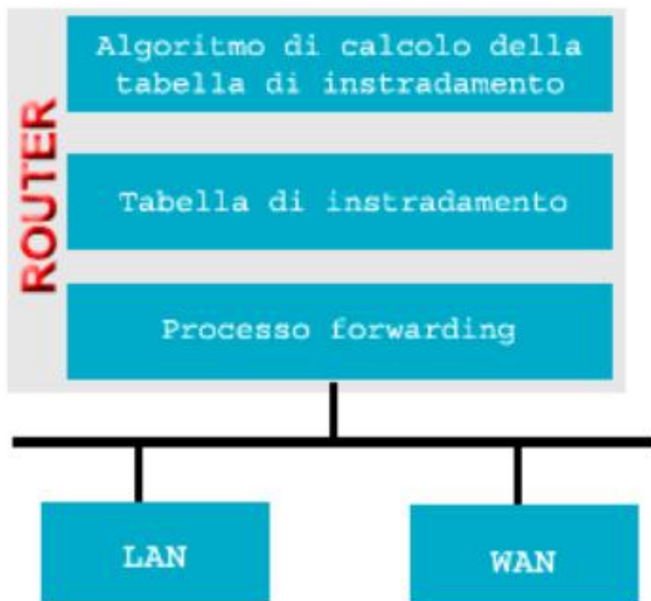
Schema dei blocchi funzionali di un router
