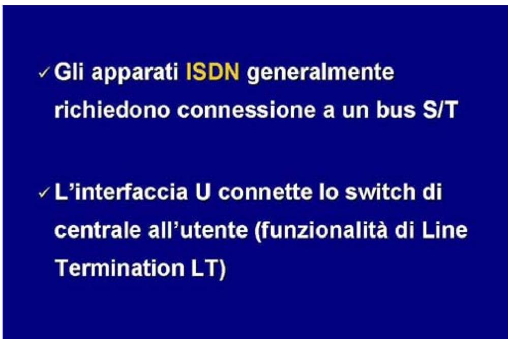
Gli apparati ISDN (telefoni, schede, bridge, router) richiedono tutti una connessione ad un bus S/T, cioè hanno lo standard pari alla connessione S/T.
