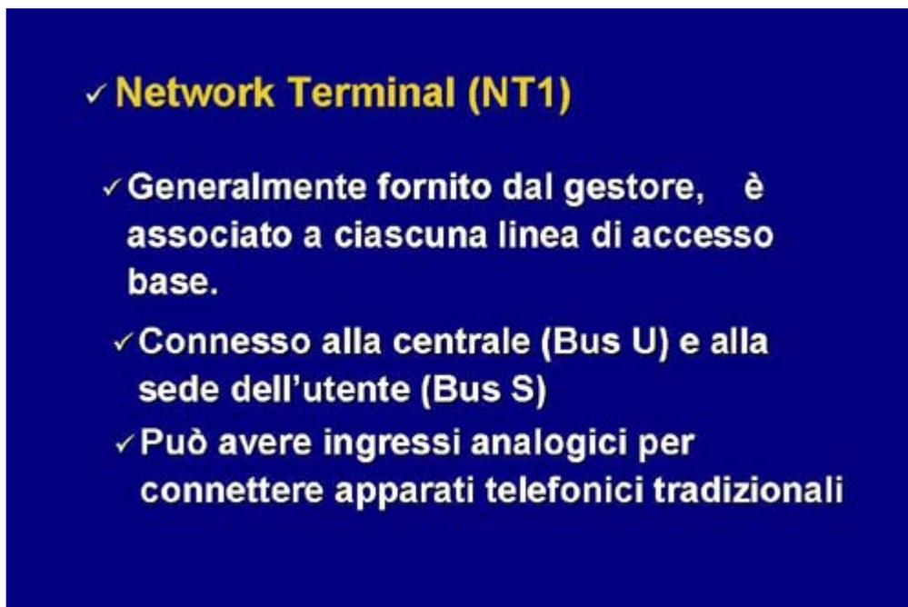
Andiamo rapidamente sulle attrezzature. Abbiamo detto che NT1 è fornito dal gestore e associato a ciascuna linea di accesso base; quindi, quando io metto la linea di accesso base, mi mettono la borchia che contiene la presa. Oltre ai punti S e T vengono definiti anche i punti Bus U e Bus S, che servono per l'interconnessione verso il gestore. Ci possono essere anche ingressi analogici per i telefoni tradizionali, questa opportunità è più un'offerta commerciale che non uno standard.
