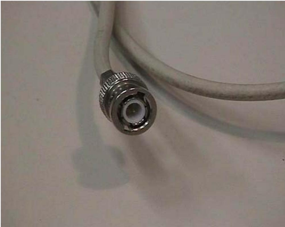
Questa che vedete è una connessione utilizzata nelle vecchie reti: viene ancora usata dove non è economico sostituirla. Si chiama connessione BNC ed è pensata per cavi coassiali infatti ha una parte esterna tonda che si collega alla massa e una parte centrale che si collega al centro del cavo coassiale. In un'altra parte del filmato vedremo come questo tipo di connessione e questi cavi vengono utilizzati per poter operare nei vecchi modelli di reti.
