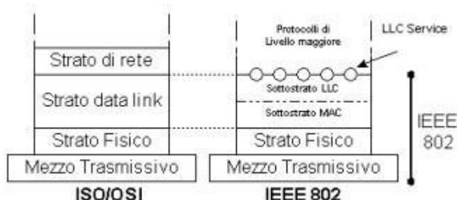
Il modello IEEE 802 si conforma al modello ISO-OSI, inquadrandosi perfettamente nei primi due livelli, fisico e di collegamento. Tuttavia, il modello IEEE 802 suddivide il secondo livello in due sottolivelli:
