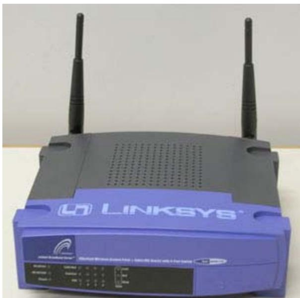
Nel manuale del dispositivo troviamo ovviamente tutte le istruzioni passo-passo su come procedere. Per prima cosa colleghiamo l'AP all'infrastruttura di rete cablata come nell'esempio *Infrastructure* e procediamo con il *set-up* dell'IP perché sia contattabile dalla rete locale.
