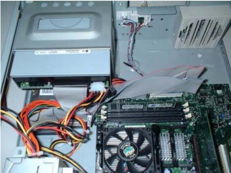
Inserimento delle schede PCI (*Peripheral Component Interconnect*), scheda di rete e scheda video. Maneggiare con cura queste schede ed evitare di strisciarle su superfici plastiche o vestiti, poichè potrebbero crearsi scariche elettrostatiche pericolose per i dispositivi elettronici.
