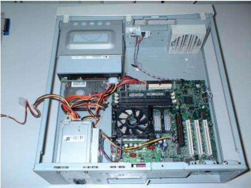
Collegamento dell'HD (*Hard Disk*) e del masterizzatore alla scheda madre tramite piattine. I cavetti multicapi vanno inseriti con la polarità giusta sia sulla scheda che sui dispositivi. Il capo numero 1 è contrassegnato da una striscia colorata.
