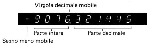
I termini **visualizzatore** e **registro del visualizzatore** non sono sinonimi. Visualizzatore si riferisce soltanto alle cifre che si possono vedere nella finestra del visualizzatore. Il **registro del visualizzatore** è un apposito registro interno che contiene i risultati con 13 cifre.
